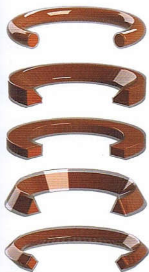
Рисунок 1 – Различные варианты исполнения резиновых колец во фторопластовой оболочке
