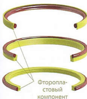
Рисунок 2 – Комбинированные уплотнения с РФК в качестве упругого элемента
