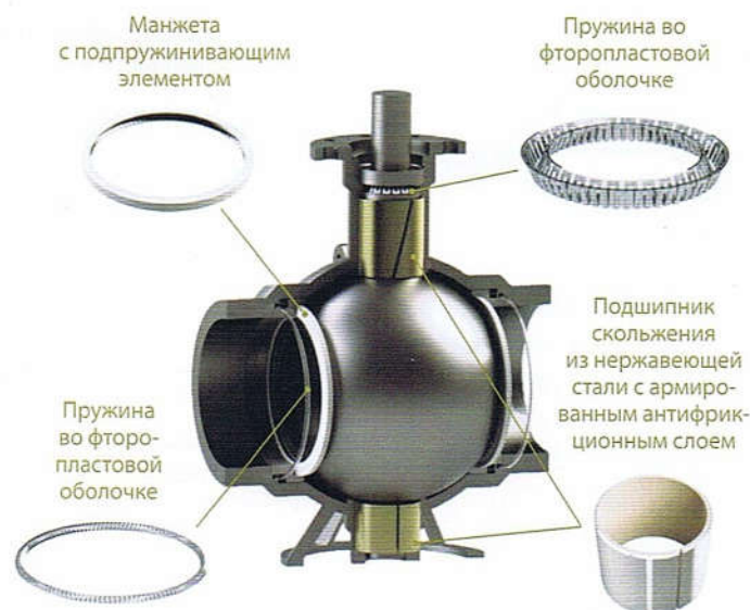
Рисунок 11 – Некоторые конструктивные решения для трубопроводной арматуры, предназначенной для эксплуатации при экстремально высоких и низких температурах
