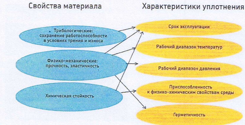
Рис. 1. Основные зависимости между свойствами материала и эксплуатационными характеристиками уплотнения
