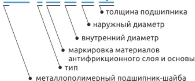
В зависимости от выбранной основы изделия – листовая сталь или сетка подшипники делят на два типа – **подшипники на основе из сетки из нержавеющей стали** (ТИП 1) и **подшипники на основе из листового металла различных исполнений** (ТИП 2).
