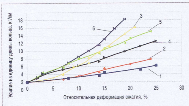
Рис. 4. Зависимость линейного усилия от деформации сжатия кольца с диаметром сечения 5,8 мм: 1, 4 – РФК с сердечником твердостью 50 Шор А; 2, 5 – 70 Шор А; 3, 6 – 85 Шор А; 1, 2, 3 – толщина оболочки 0,2 мм; 4, 5, 6 – толщина оболочки 0,7 мм
