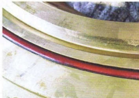
Рисунок 4 – Пример применения РФК в седловом уплотнении шарового крана
